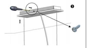
• Remonter les 2 enjoliveurs jusqu'aux plaques de suspension et les fixer avec les vis fournies (voir 6).
